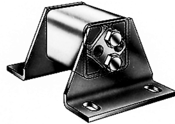
Fig. 12 Mediante staffe WS e bulloni o viti
