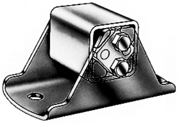
Fig. 11 Mediante staffa UV e bulloni o viti
