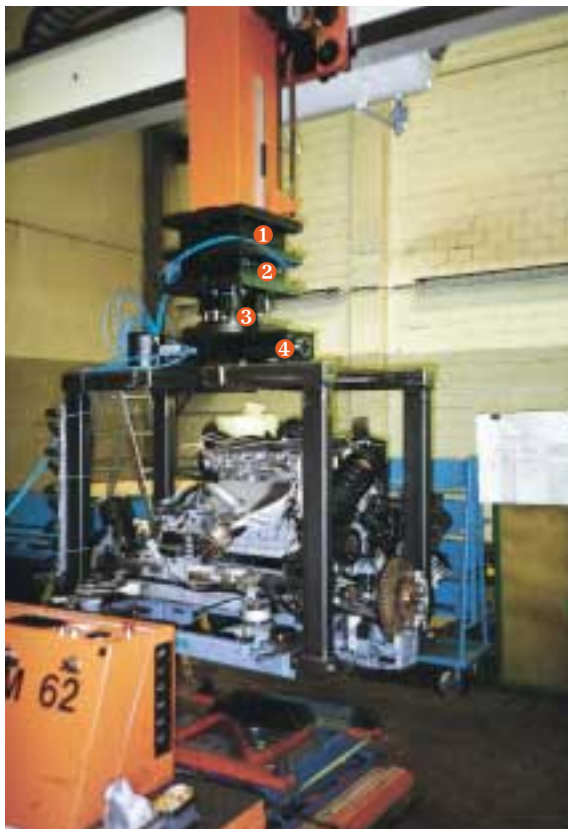
① = KA 300, ② = RT 300, ③ = ZN 300, ④ = Pinza speciale con corsa da 200 mm
