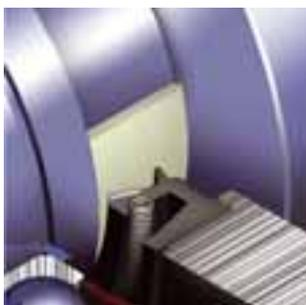
**NUOVO sistema di tenuta brevettato - lato ingresso** - elimina la coppia resistente, abbate l'attrito ed il riscaldamento. L'abbinamento di una bussola in ceramica (durezza **1700Hv**, livello di finitura **0,2 µm**) e una guarnizione a doppio labbro MBR con ricopertura in Teflon è estremamente resistente all'usura, al logoramento delle superfici. Questo brevetto assicura l'assenza di perdite ed una durata superiore a 30 000 ore.
