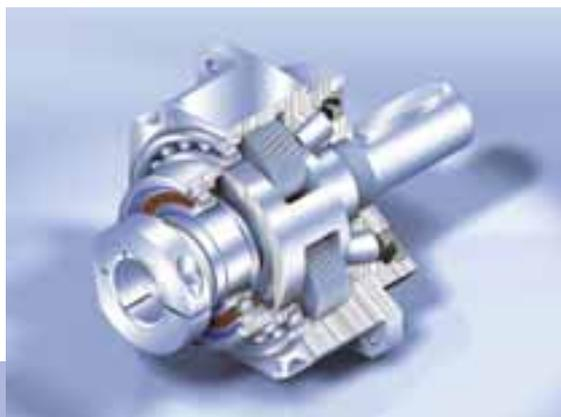
**Portasatelliti brevettato**, con integrato il cuscinetto dell'ingranaggio solare, elimina ogni possibile disallineamento degli ingranaggi e realizza la maggiore precisione disponibile sul mercato. Inferiore a 1 arcmin.
