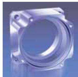
**L'ingranaggio a dentatura interna**, lavorato direttamente nella carcassa monoblocco in acciaio, ha un diametro maggiore e più denti. La capacità di coppia e la densità di potenza sono massimizzate.
