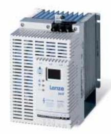
La programmazione viene eseguita direttamente sull'inverter oppure tramite un dispositivo di programmazione EPM a batteria. In tal modo è possibile impostare o modificare le configurazioni offline, in tutta comodità. Il dispositivo è in grado di memorizzare fino a 30 diversi programmi per l'azionamento in forma di file. In pochi secondi, con la semplice pressione di un pulsante, è possibile copiare da EPM a EPM, importare un file nell'EPM o esportare un file dall'EPM.
